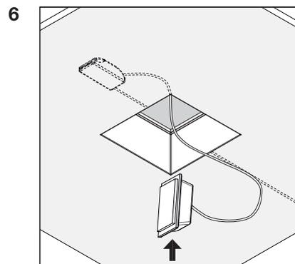
Устанавливать световой модуль в корпус следует, предварительно повернув его под 90° от рабочего положения.
