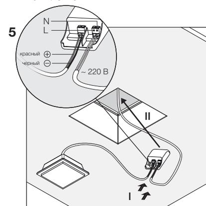
Подключите световой модуль (поз. 2) к блоку питания (поз. 3). Блок питания к электросети (см. схему подключения), а затем установите его за гипсокартонный потолок.
