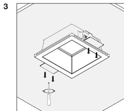
Установите корпус (поз. 1) в отверстие и закрепите его с внешней стороны потолка саморезами, идущими в комплекте (поз. 6).
